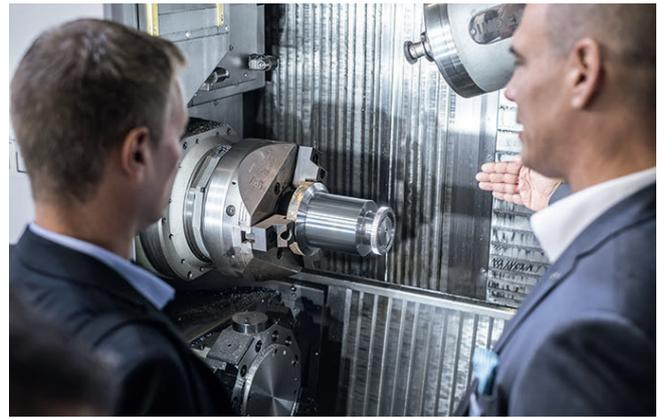
2 Ein Trend im Werkzeugmaschinenbau ist die zunehmende Integration von Technologien im Sinne einer möglichst weitgehenden Komplettbearbeitung in einer Aufspannung © Landesmesse Stuttgart
